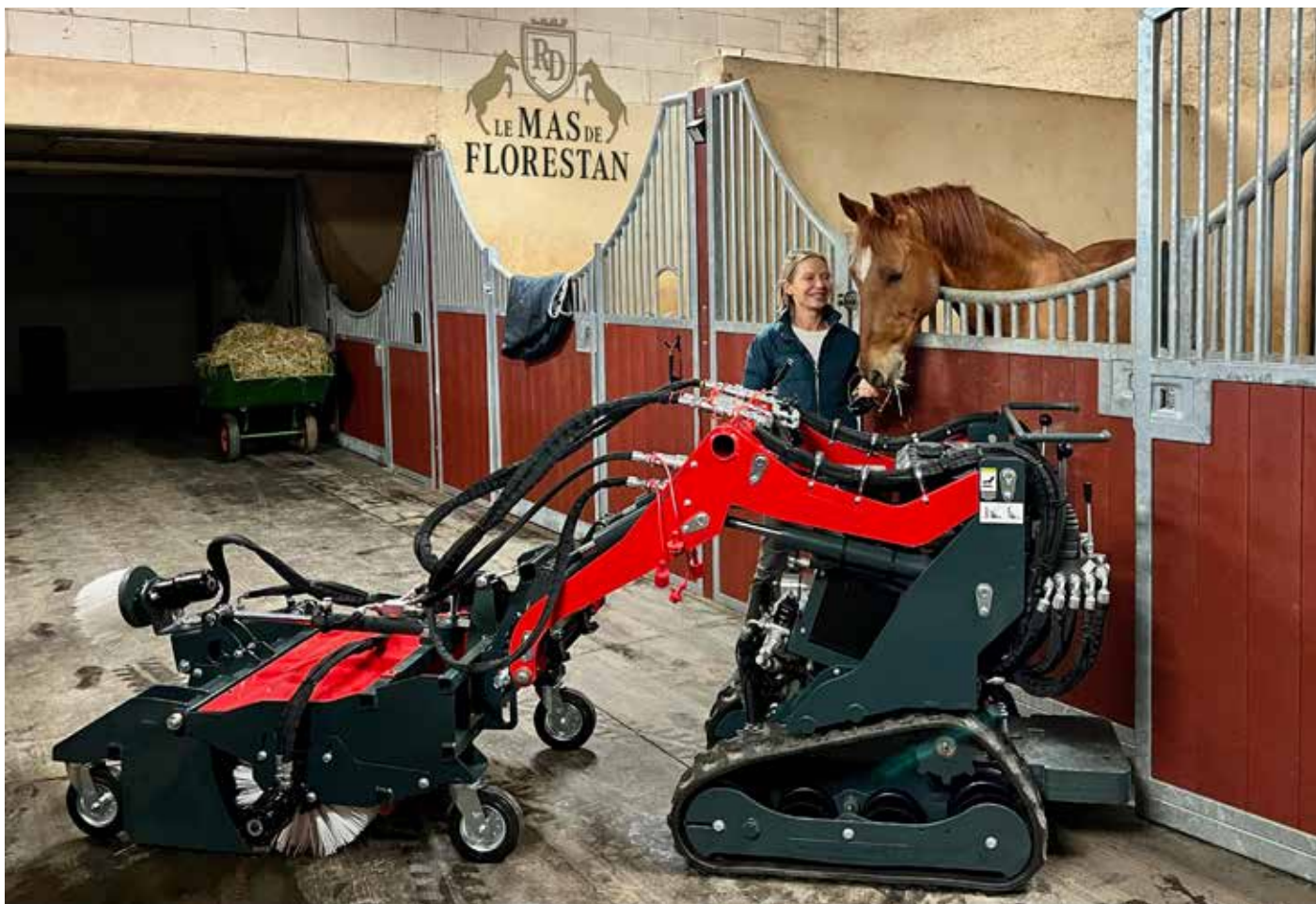
Spazzatrice ad asse orizzontale per microBull, con spazzola laterale e cassetto di recupero
