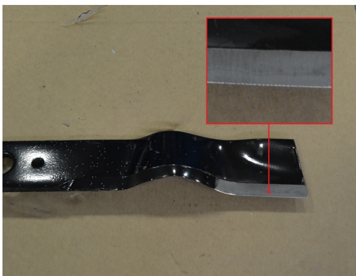
Filo della lama in perfetto stato
